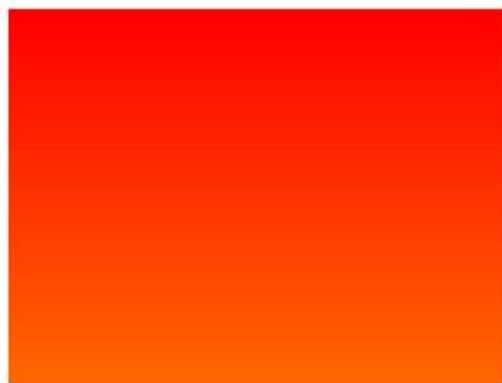
Abb. 3b: wenn es so aussieht, befindet sich unter dem Fernseher eine Magnetquelle, z.B. ein Lautsprecher
